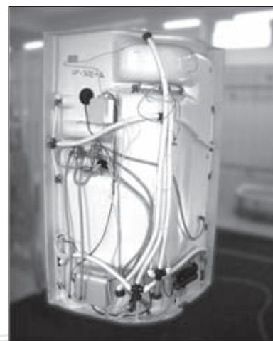
8. Posazení středního dílu na vaničku, dbát na přesné dosednutí stěny na předem vyvrtné díry pro zajištění sešroubování stěny s vaničkou
