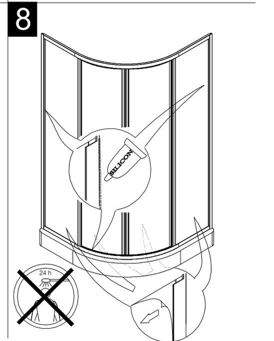
IP00043.0 - SV343 - Panel connection / Montážní výkres panelu
