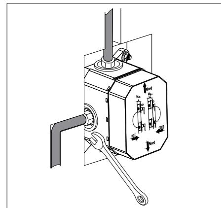
Připojte přívody studené a teplé vody do R-boxu. Stejně tak připojte přívod pro sprchu do R-boxu
