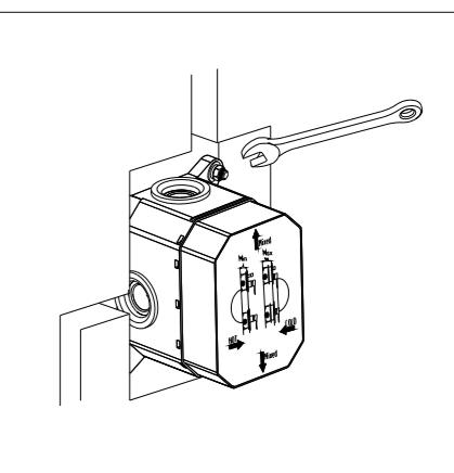
Vložte R-box do hlavního otvoru ve zdi a upevněte pomocí 4 šroubů klíčem. Dříve než klíčem dotáhnete šrouby, ujistěte se, že R-box dobře zapadl do otvoru ve zdi.
