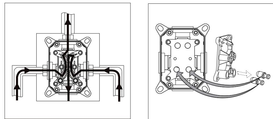
Odmontujte krycí desku z vestavěného těla, vložte 2 zálepky výtoku vody dle obr. Poté znova nainstalujte krycí desku.
