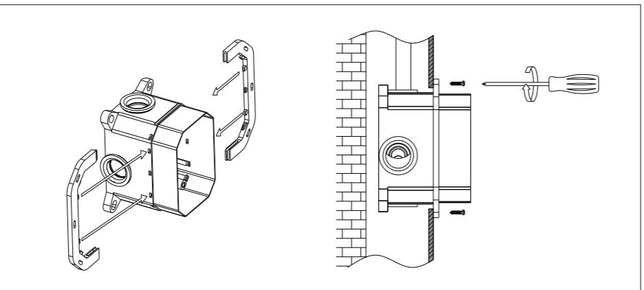
Pokud je stěna dutá, upevněte R-box pomocí montážních rámečků dle obrázku, poté zafixujte R-box ke zdi pomocí samořezných šroubů.
