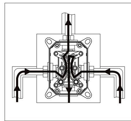
Otevřete uzávěr vody na pár minut, aby se trubky propláchly a vyčistily od písku.
