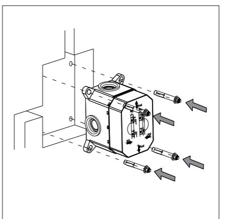
Vyrtejte instalační otvor ve zdi pro R-box v potřebné velikosti. Poté vyvrtejte 4 polohovací otvory na šrouby podle vyznačených bodů.
