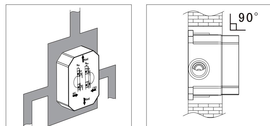
Poté, co jste se ujistili, že je vše správně utěsněné, zafixujte R-box a vodní trubky cementem.
