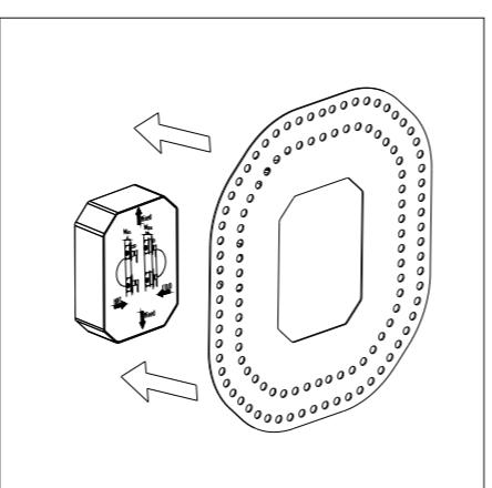
Důležité: ujistěte se, že vystupující část R-boxu je přímo kolmá k povrchu zdi. Je to nezbytné pro obklady na zdi.
