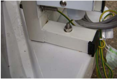
Použít šrouby M6x50 use screws M6x50
