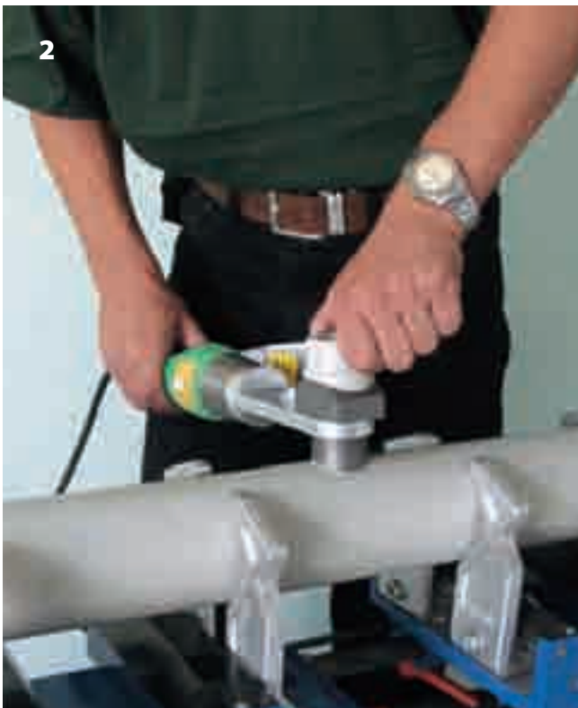
Navařovací sedlo nasuneme na nástavec tak, aby na sebe navazovaly rysky na sedle a nástavci. Prohřejeme otvor i navařovací sedlo. Doba prohřívání je stejná jako u průměru 32 mm (8 s). V případě sedel 110 x 32 a 110 x 40 mm je doba prohřívání jako u průměru 40 mm – 12 s.
